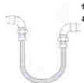
Utiliser des coudes et monter le tuyau en forme de U
